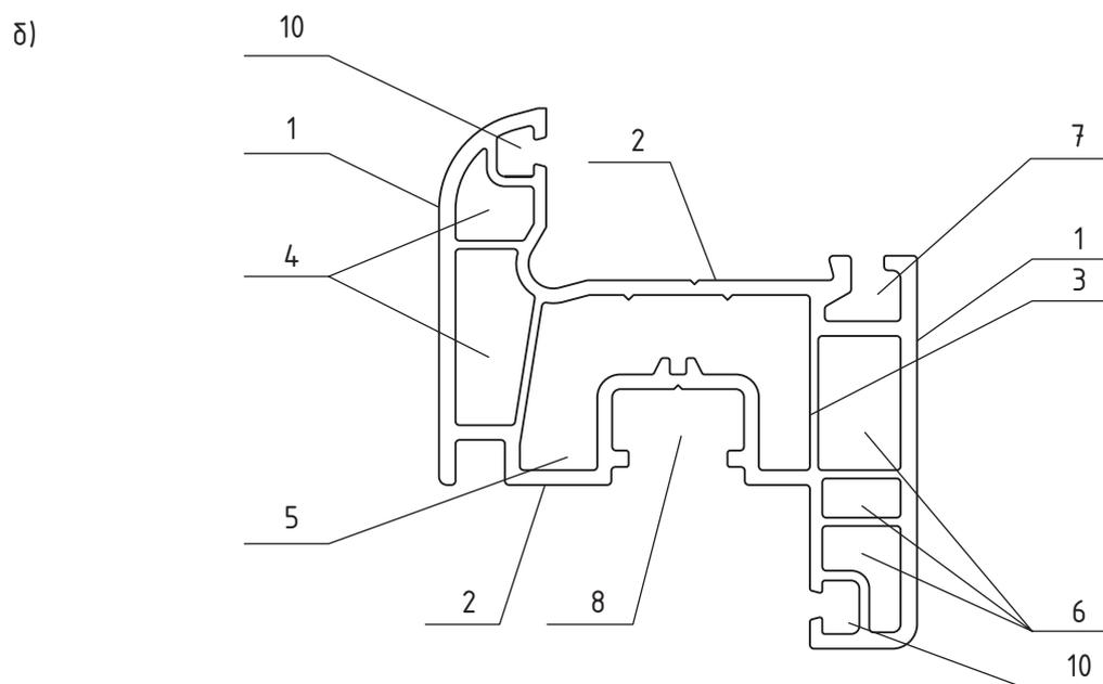
а) - поперечное сечение профиля коробки; б) - то же, створки
