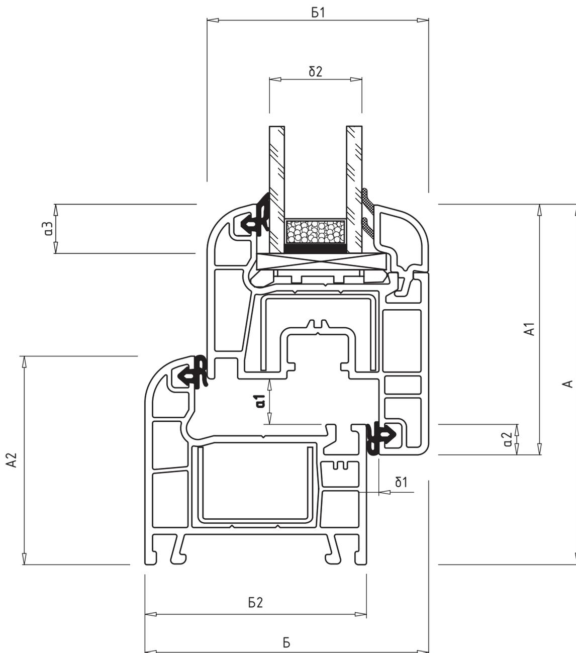
A - высота комбинации профилей; A1 - высота профиля створки; A2 - высота профиля коробки;
